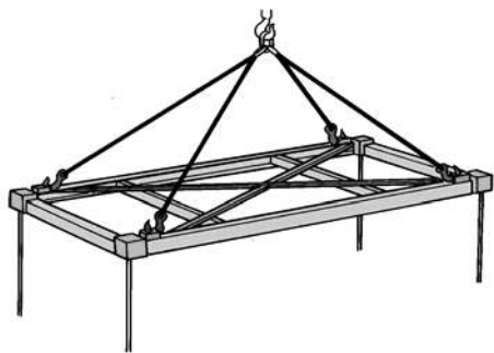
Пример подъема контейнера при помощи траверсы с крюками, скобами или замками, закрывающимися вручную.
